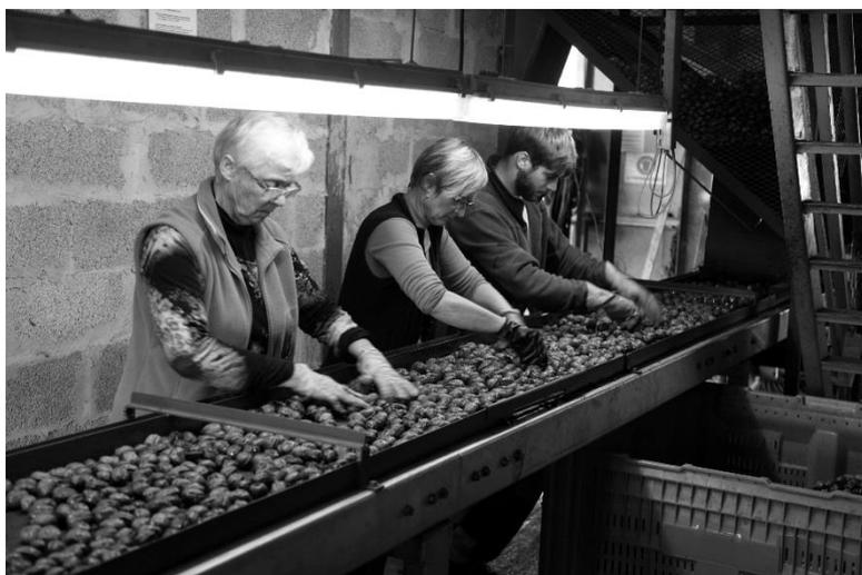
Un énergique lavage mécanique suivi d'un premier tri visuel, sont écartées toutes celles qui sont abimées, avec leur coque et quelques débris de noix. Les noix partent vers les séchoirs ou l'air chaud est pulsé par d'énormes ventilateurs.
